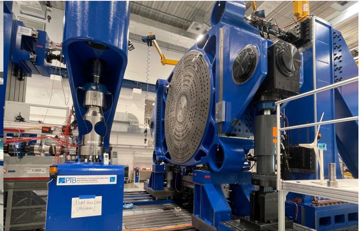
Das ist weltweit einmalig. Bei der PTB steht die größte Maschine zur präzisen Messung der Kräfte, die auf Windkraftanlagen einwirken.
